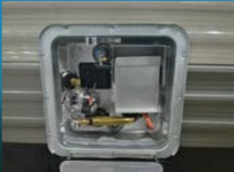
Chauffe-eau DSI gaz/électrique de 6 gallons
