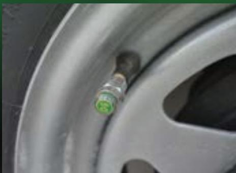
Système de surveillance de la pression des pneus
