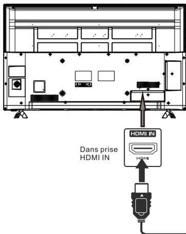
Raccordez un câble HDMI (non compris) comme montré : Assurez vous de raccorder le c ble provenant de la source (HDMI OUT) cet appareil (HDMI IN)
